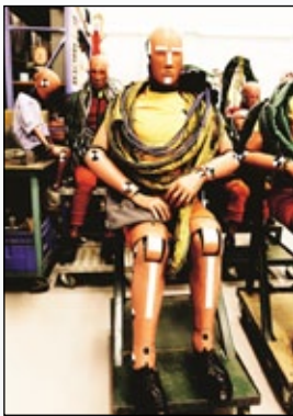
Etupenkeille asennettavat testinuket vastaavat aikuista ihmistä. Keula- ja sivutörmäyksessä käytetään erityyppisiä nukkeja kolarien erilaisuuden vaatiman mittalaitteiston takia.
